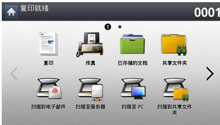
**已存储的文档**允许您将扫描的数据存储在机器的大容量存储设备（硬盘）中。已存储的数据可发送到不同目标，如**传真**、**电子邮件**、**服务器**或**USB**。
